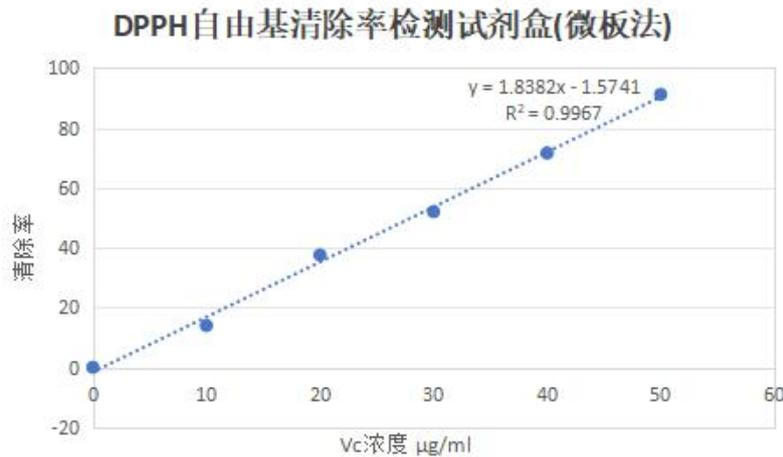
由上图可知：Vc 标准工作液在 0~50 $\mu\text{g}/\text{ml}$  时线性关系良好，·DPPH 清除率与 Vc 浓度呈正相关，当 Vc 浓度大于 50 $\mu\text{g}/\text{ml}$  时，·DPPH 清除率接近最大值，数据有偏差。
