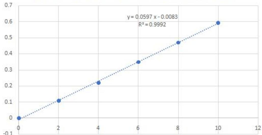
注意: 由于检测仪器和操作手法等条件的不同, 参考值范围会有波动, 该值仅供参考, 对于要求精确计算 AA 含量的, 可以采用标准曲线进行多点重复测定; 根据 Yuanye 测定经验显示氨基酸浓度在 0.5μg/ml 以下及 20μg/ml 以上, 标准曲线会有偏差。
